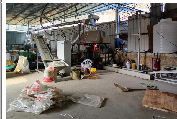
废气收集装置
